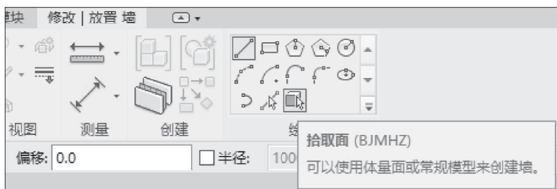
图 4-37 “拾取面”工具绘制墙体
