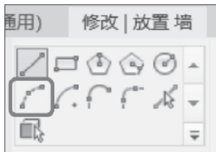
图 6-15 使用“起点-终点-半径弧”绘制幕墙
